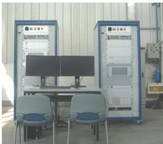
软硬件在环仿真试验台
